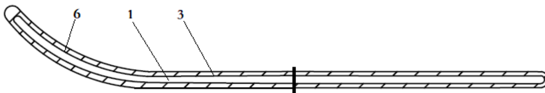
1-芯丝 3-聚合物护套 6-头端弯曲 导丝结构示例图 7
